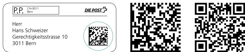
Abbildung 25: Beispiel eines Matrix-Codes und Unterschiede zum QR-Code (Quellen: Post CH AG, Factsheet Letter-ID)
